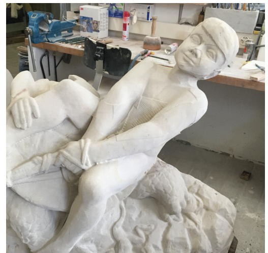
Produkt aus der Fräsmaschine. Die von der digitalen Erfassung herrührenden Reliefpuren sind noch gut zu erkennen und mussten von den Bildhauern überarbeitet werden
